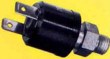
Bei geschalteter Klimaanlage herrscht ein bestimmter Kältemitteldruck. Auf der Niederdruckseite darf dieser Druck nicht unter 2 bar absinken. Mit dem Niederdruckschalter wird die Niederdruckseite abgesichert. Sinkt der Druck unter 2 bar, spricht der Schalter an und trennt die Stromversorgung zur Magnetkupplung (N25). Die Klimaanlage ist abgeschaltet.
