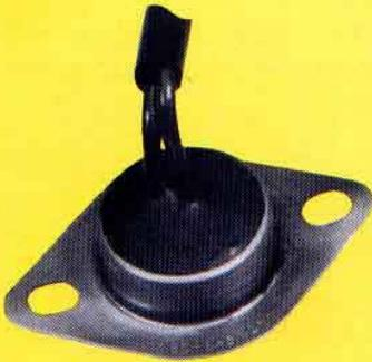
Er stellt sicher, daß bei Außentemperaturen unter 5°C die Klimaanlage nicht betrieben werden kann. Wird eine Außentemperatur unter 5°C gemessen, so unterbricht der Schalter die Stromversorgung zur Magnetkupplung des Kompressors.
