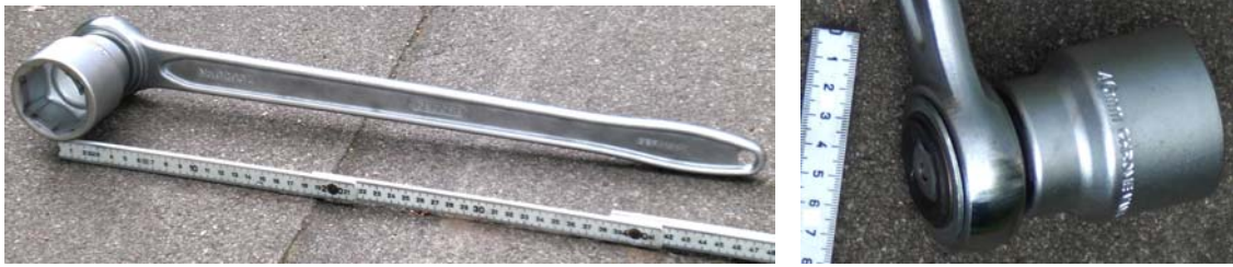
Abbildung 21a und b: Nuss (SW 46 mm) mit 3/4"-Vierkant-Antrieb und Ratschenschlüssel
