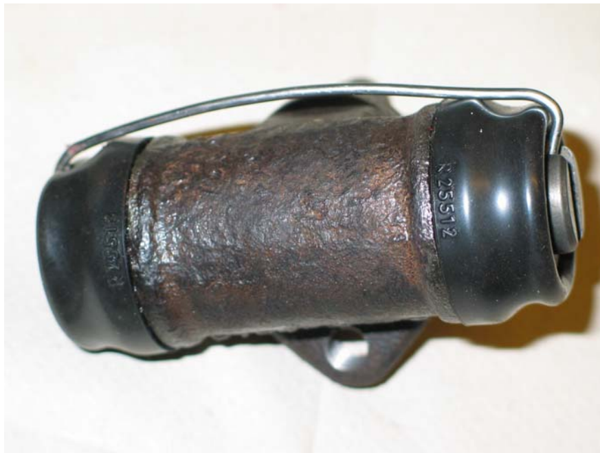
Abbildung 28: Radbremszylinder (demontiert) mit aufgesteckter „Montagehilfe“ („Montagehilfe / Drahtbügel“ gefertigt aus gekürzter und passend gebogener Fahrradspeiche)
