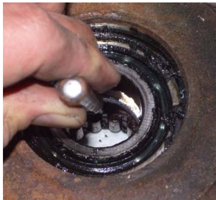
Abbildung 14: Austreiben des Zylinderrollenlagers mit einem Splintentreiber
