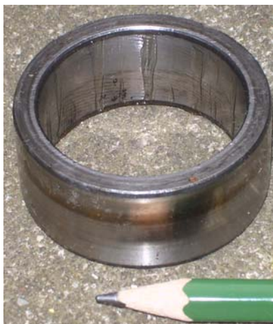
Abbildung 11: alter Lagerinnenring des Zylinderrollenlagers
