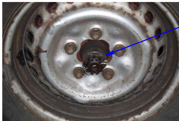
Abbildung 2: Die zentrale Kronenmutter (Kronenmutter, M30 x 1,5, SW 46mm) am Fahrzeug auf der Radlagerwelle montiert
