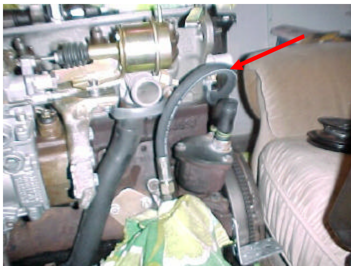
Neue Öldruckleitung zum Turbolader am Ölfilterflansch (Pfeil)...
