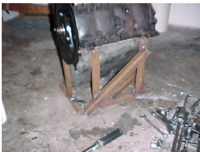
Das Montagegestell, deutlich zu erkennen, das es sich am Rand der Ölwanne abstützt
