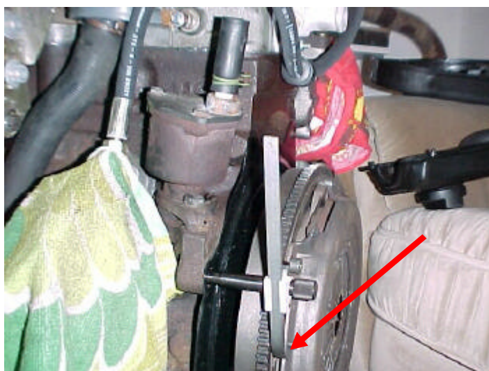
Das Spezialwerkzeug 2068 A in Einbauposition. Der Stab mit der Einteilung wird auf 100 mm eingestellt, wobei bei der Einteilung auf der kleinen Skala der linke (obere) Strich die Bezugslinie ist. Die Spitze (Pfeil) muss jetzt in die Kerbe auf dem Kupplungsgehäuse greifen. Andernfalls vorsichtig die Kurbelwelle so drehen, dass es passt. Sollte beim Drehen der Kurbelwelle ein Widerstand auftreten, dann die Kurbelwelle vorsichtig andersherum drehen.
