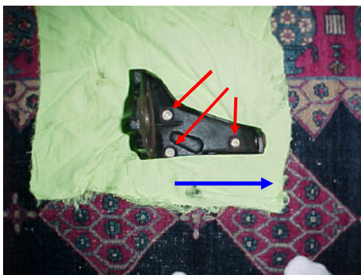
Die Konsole, die roten Pfeile markieren die Löcher, die um etwa 4 mm aufgefräst werden müssen und der blaue Pfeil die Fräsrichtung (nur AAZ-Halter mit JX-Pumpe)
