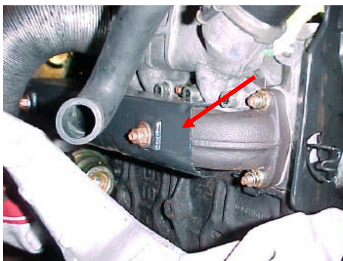
Der montierte Krümmer mit den Wärmeschutzblechen (Pfeil), darüber in hellerem Aluminium mit den Inbusschrauben das Saugrohr
