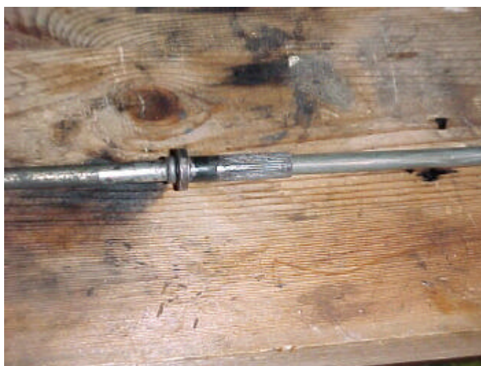
Der Ölpeilstab mit aufgeschobener Hülse vom alten AAZ/1Y-Peilstab
