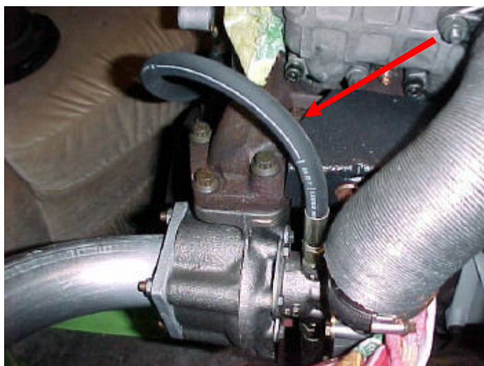
... und am Turbolader (Pfeil). Die Rücklaufleitung ist auf dem nächsten Bild zu sehen (Pfeil rechts) nur AAZ.
