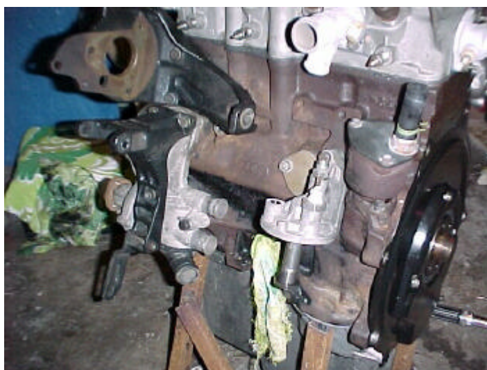
Montierte Wasserpumpe mit Halter für die Lichtmaschine
