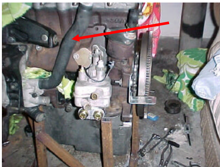
Montierter Kühlwasserschlauch für den kleinen Kühlwasserkreislauf
