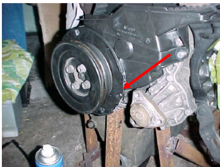
Nach der Montage des unteren Zahnriemenschutzes werden die Riemenscheiben auf der Kurbelwelle montiert. Der Pfeil zeigt die Ecke, die entfernt werden muss.
