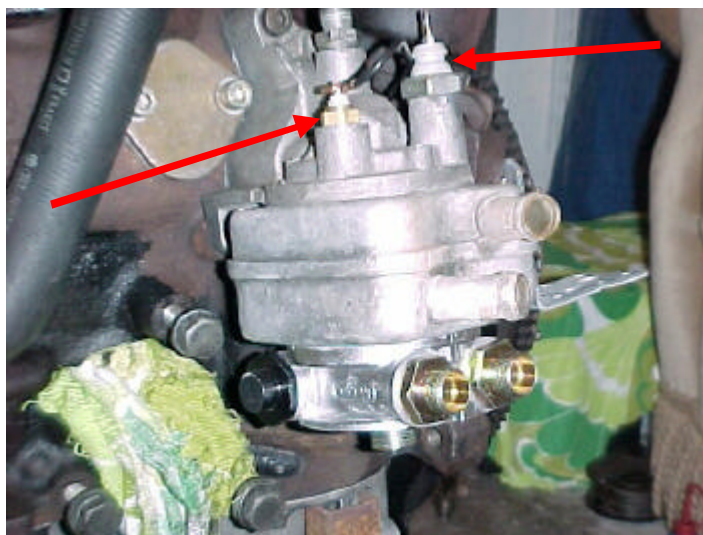
Der Ölfilterflansch mit Öl-Wasser-Wärmetauscher und der Anschluss für den Ölkühler. Der Putzlappen links im Bild verschließt vorläufig die Öffnung für den Ölpeilstab, der im Moment nur stören würde. Ebenfalls angesetzt sind die drei Schrauben für den Motorhalter und der Schlauch von der Kühlwasserpumpe zum Wasserflansch am Zylinderkopf für den kleinen Kreislauf. Die Pfeile markieren den Öldruckschalter (rechts) und den Temperaturfühler für das VDO-Instrument auf der Schalttafel.
