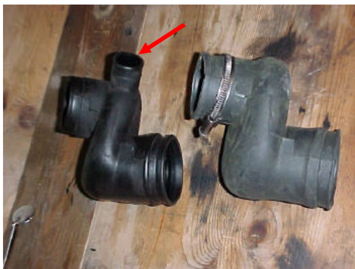
Das Bild zeigt links die alte Version des Verbindungsstückes und rechts die neue Ausführung. Der Pfeil zeigt den Unterschied (nur AAZ).
