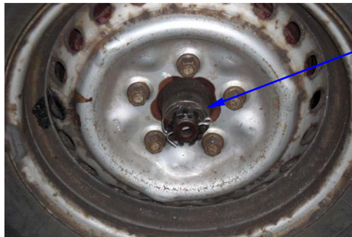
Abbildung 2: Die zentrale Wellenmutter (Kronenmutter, M30x1,5, SW 46mm) am Fahrzeug auf der Radlagerwelle montiert
