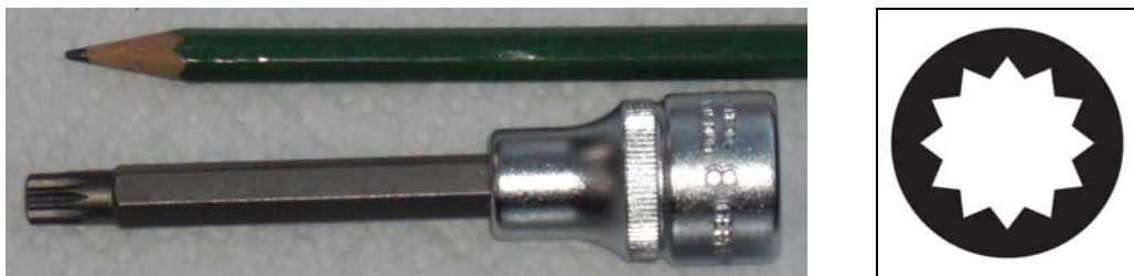
Abbildung 22a und b: links: Vielzahn-Nuss, 8 mm mit 1/2"-Vierkant-Anschluss; rechts: Profil des Vielzahns
