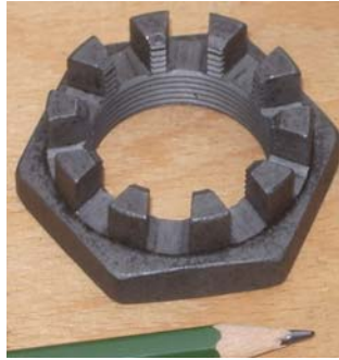
Abbildung 8: die zentrale Wellenmutter (Kronenmutter) M30x1,5 mit 10er Splintteilung (ähnlich ISO 7038 – M30 x 1,5)
