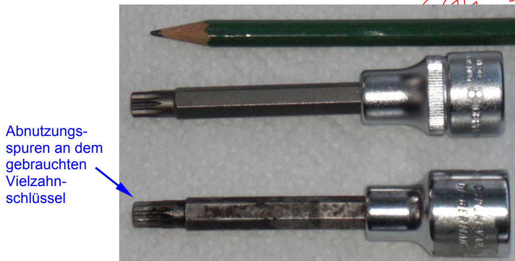
Abbildung 6: Vielzahn-Nuss, 8 mm mit 1/2"-Vierkant-Anschluss (oben: unbenutzt, unten: häufig benutzt)
