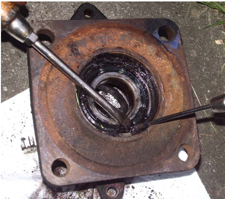
Abbildung 13: Heraushebeln des Sicherungsring mit Hilfe von zwei Schraubendrehern
