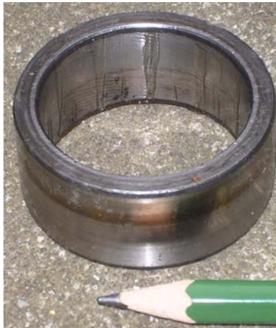
Abbildung 11: alter Lagerinnenring des Zylinderrollenlagers
