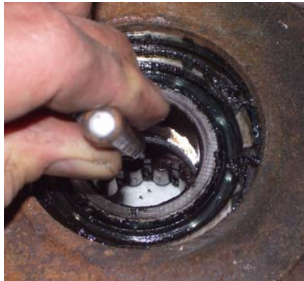
Abbildung 14: Austreiben des Zylinderrollenlagers mit einem Splintentreiber
